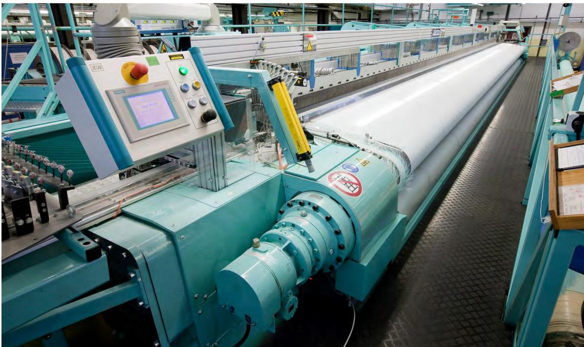
Webmaschine für Papiermaschinenbespannungen ©Schlatter
