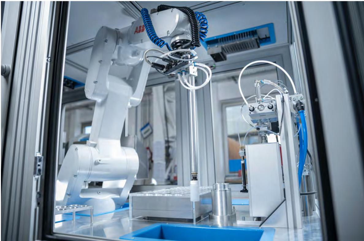
polab®Cal, vollautomatischer isothermer Kalorimeter ©thyssenkrupp Polysius
